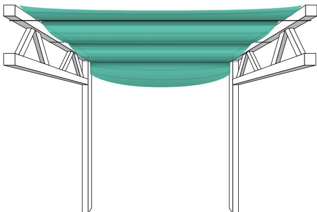
Lorsque la longueur de l'écran doit être ajustée, faites une coupe à chaud ou utilisez des ciseaux. Vous pouvez également utiliser une bande collante résistante aux UV et couper sur la bande (1).
